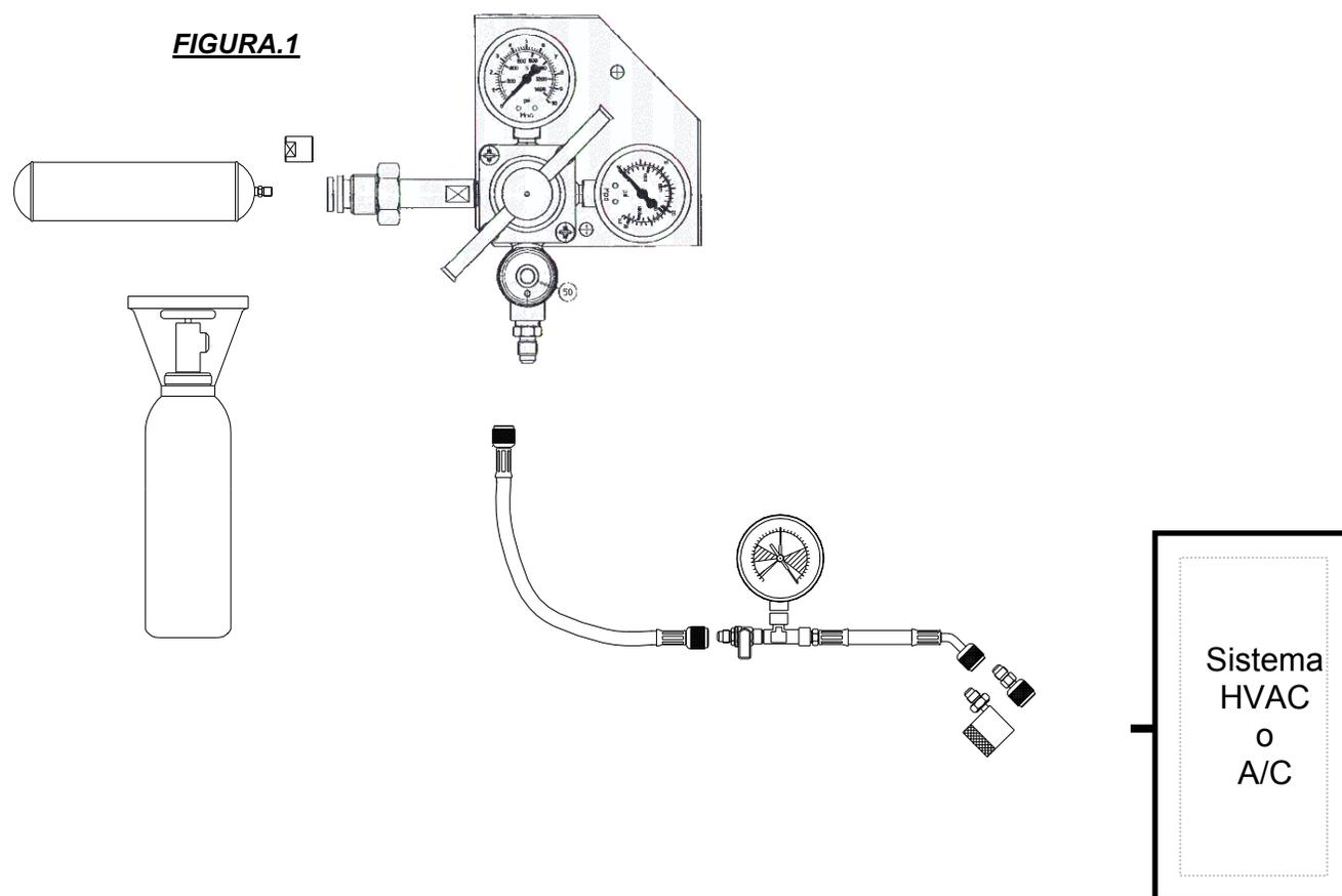
Utilizzando cartucce da 950cc. può accadere che la pressione nella bombola sia insufficiente al raggiungimento della pressione di test richiesta nel sistema. Utilizzare una bombola nuova per raggiungere la corretta pressione di test. Il contenuto residuo della bombola potrà essere utilizzato per operazioni per le quali è richiesta una bassa pressione (flussaggio durante la saldatura) o per effettuare una successiva pressurizzazione a valori minori.
